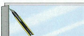
完成直後はまだ施工液が多少残り、フィルムの色も透明度も悪く見えますが、1~2週間で徐々に水分もなくなり、乾燥後は完全に濁りも消えていきます。その間は強くこすったりすると、破れたり剥がれやすいため注意が必要です。
