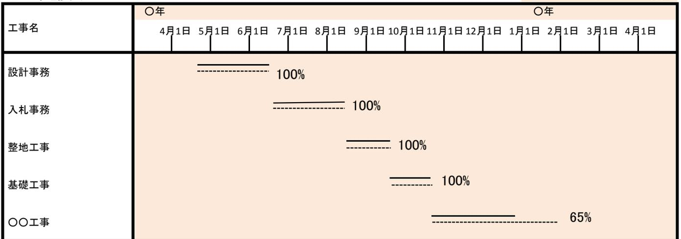
1. 工事予定を点線の棒線で示し、その上に工事進捗状況を実線の棒線で示すこと。
