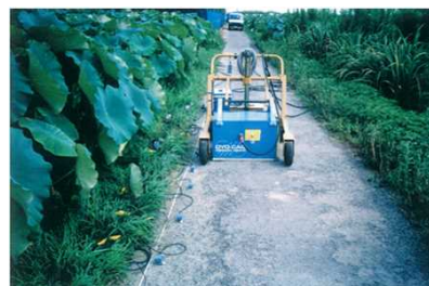
浅層反射法弾性波探査測定状況
